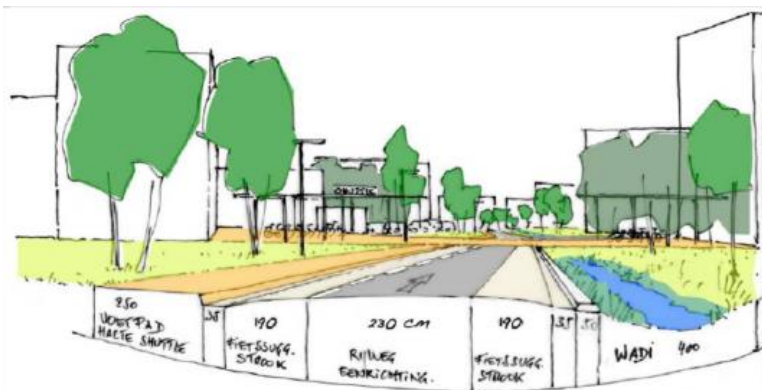
Figuur 8: toekomstige inrichting van het Tech Lane Ghent science park – campus A. Eénrichtingsverkeer met brede fietssuggestiestroken om de rijweg visueel te versmallen en fietsers een plaats te geven. Een verhoogd plein moet verder snelheidsremmend werken
