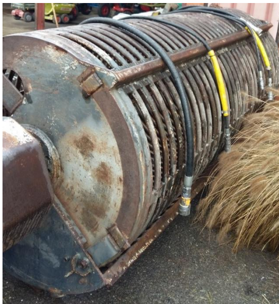
Figuur 3-5: Draaiende trommelbak die op bedrijf C gebruikt wordt
