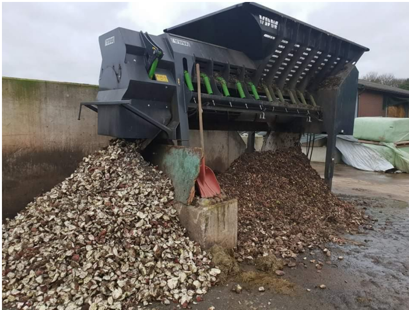
Figuur 3-4: Machine gebruikt op bedrijf F om de voederbieten te reinigen en te versnipperen
